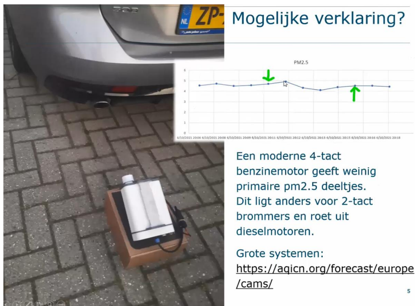
Figuur 10. Meting achter uitlaat van een benzineauto.
